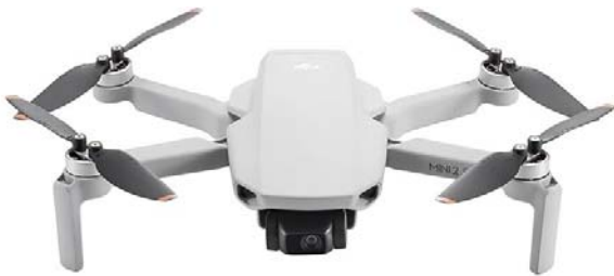
Figure 3. Quadcopter drone (DJI Mini 2 SE)
